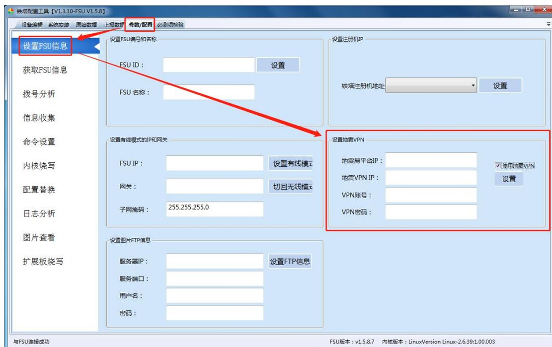
填写铁塔或地震局提供的地震局服务 IP，地震局 VPNIP、账号、密码等信息，并勾选“使用地震 VPN”，点击【设置】。等待设置完成，并弹出如下提示：
