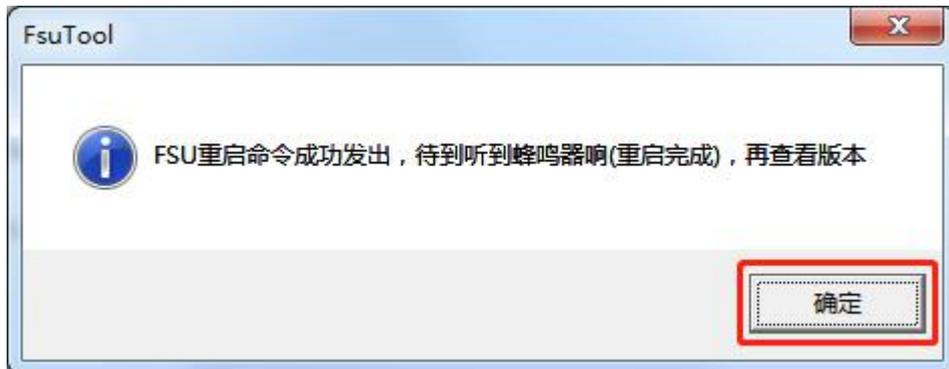
FSU 设备重启完成后，查看工具右下方显示的“FSU 版本”显示版本号为 v1.5.8.7，说明升级成功。
