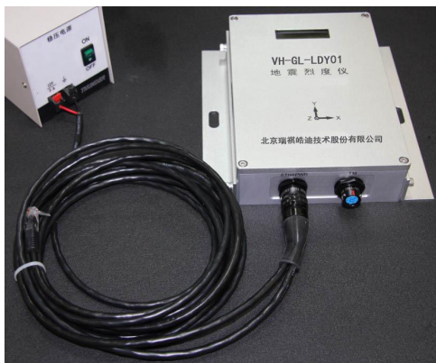
图 2.5.1-1 VH-GL-LDY01 与稳压电源连接示意图
