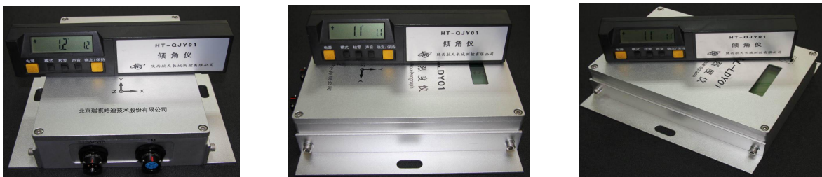
图 2.2.3-1 VH-GL-LDY01 水平调节示意图
