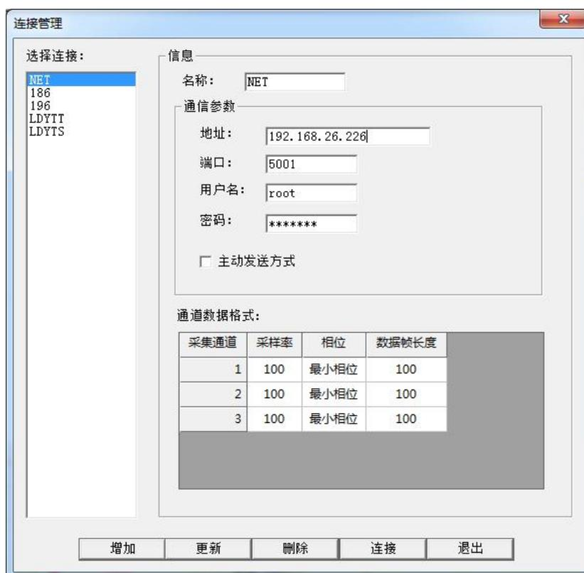
④ 连接成功后，在菜单【设置】→【通信参数】→【网络地址】中，设置烈度仪的 IP 地址、子网掩码、网关等信息。
