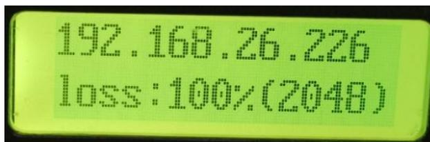
② 设置电脑 IP 成与烈度仪的 IP 同网段的 IP 地址。如：烈度仪的 IP 为 192.168.26.226，则电脑可设置为 192.168.26.50。
