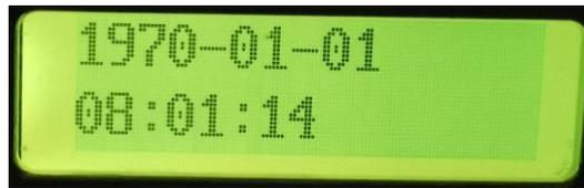
如果重启后，时间能够自动校时，则说明烈度仪设置没有问题，并且自动校时动能没有问题。
